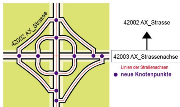
Abbildung 19: Herstellung der Topologie bei der Umwandlung von physisch getrennten zu einfach modellierten Straßen
