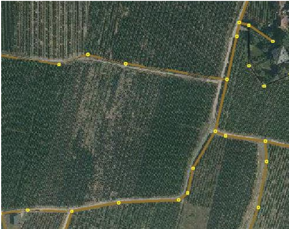
Abbildung 4: Beispiel für Lageabweichungen zwischen Modell und Örtlichkeit
