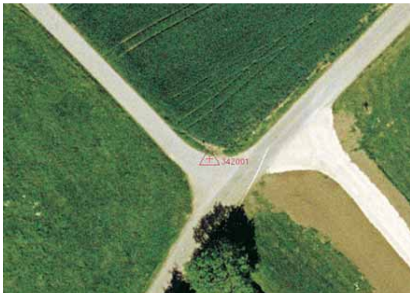
Abb. 1: Passpunkt mit Messmarke und Punktnummer
