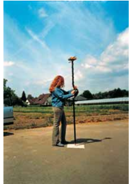
Abb. 4: Messung der Passpunkte mit GPS
