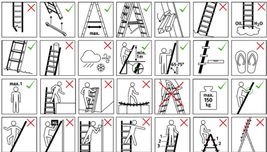
Abb. 11 Hinweise zur Verwendung von Leitern
