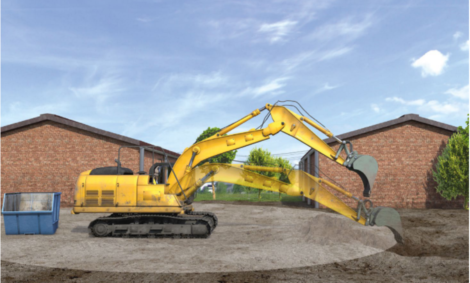
Abb. 18 Gefahrenbereich beim Betrieb eines Baggers
