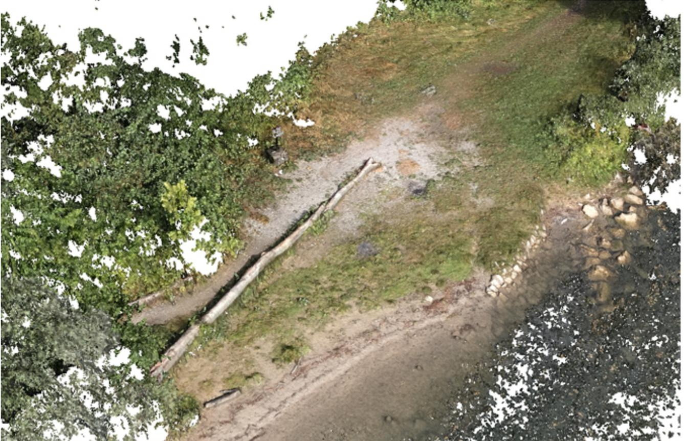
DJI M300 mit Bildsensor P1 : bildbasierte Punktwolke des Bodenseeufer
