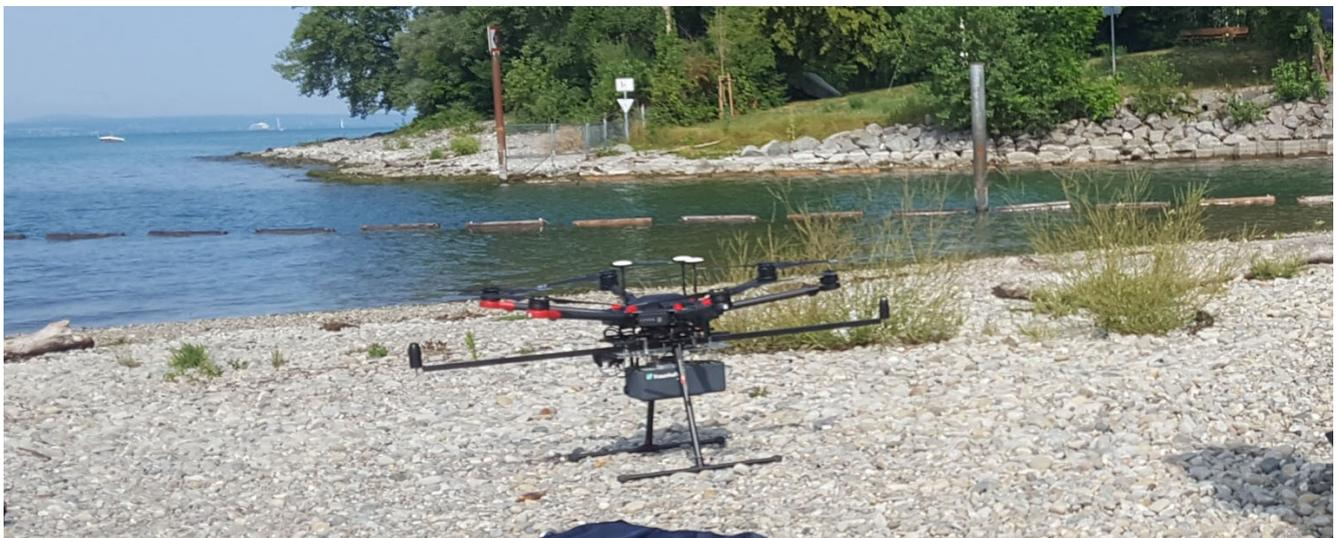
Drohne des IPM mit speziellem Lasersensor
