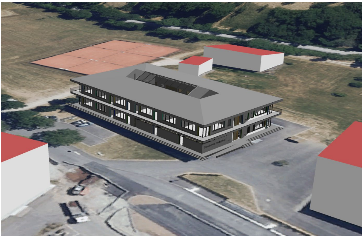
Abbildung 1: Übernahme BIM/ IFC- Modell (Grundschule Niedernhall) in die 3D- Webanwendung
