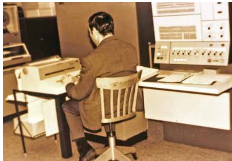
Rechenanlage IBM 360/30 Konsole
