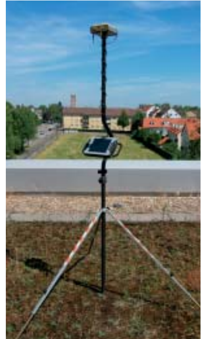
Bild 3: Mobiles GIS mit SAPOS-Rover am Lotstab
